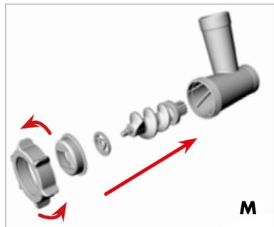
Ist die Schnecke korrekt eingesetzt ragt das Kunststoffteil einige Millimeter aus dem hinteren Teil des Schneckengehäuses heraus.
