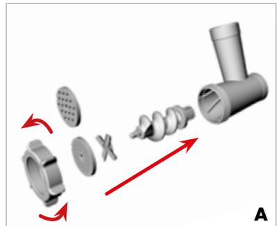
Kunststoffteil einige Millimeter aus dem hinteren Teil des Schneckengehäuses heraus. Nehmen Sie jetzt das Kreuzmesser. Stecken Sie das Kreuzmesser mit der abgerundeten Seite zur Schnecke auf die Achse der Schnecke. Die vier-eckige Öffnung in der Mitte des Kreuzmessers sollte über den Vierkant auf der Achse der Schnecke gleiten.
