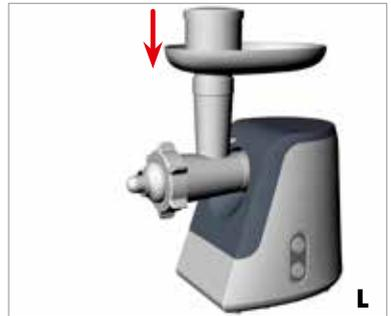
Setzen Sie jetzt den Konus auf das Schneckengehäuse und setzen Sie den Verschlussring darüber. Schrauben Sie den Verschlussring vorn am Schneckengehäuse an und ziehen Sie den Verschlussring im Uhrzeigersinn mit der Hand fest.
